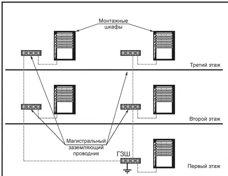
Рисунок 4 — Монтаж магистральных проводников функционального заземления
