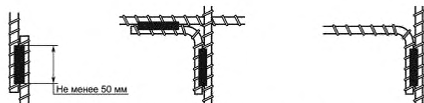
а) Сварные соединения (для тока молнии и целей ЭМС)
