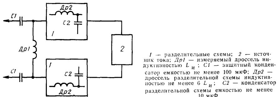
$I$  — разделительные схемы;  $2$  — источник тока;  $Dr_1$  — измеряемый дроссель индуктивностью  $L_i$ ;  $C_1$  — защитный конденсатор емкостью не менее 100 мкФ;  $Dr_2$  — дроссель разделительной схемы индуктивностью не менее 6  $L_i$ ;  $C_2$  — конденсатор разделительной схемы емкостью не менее 10 мкФ
