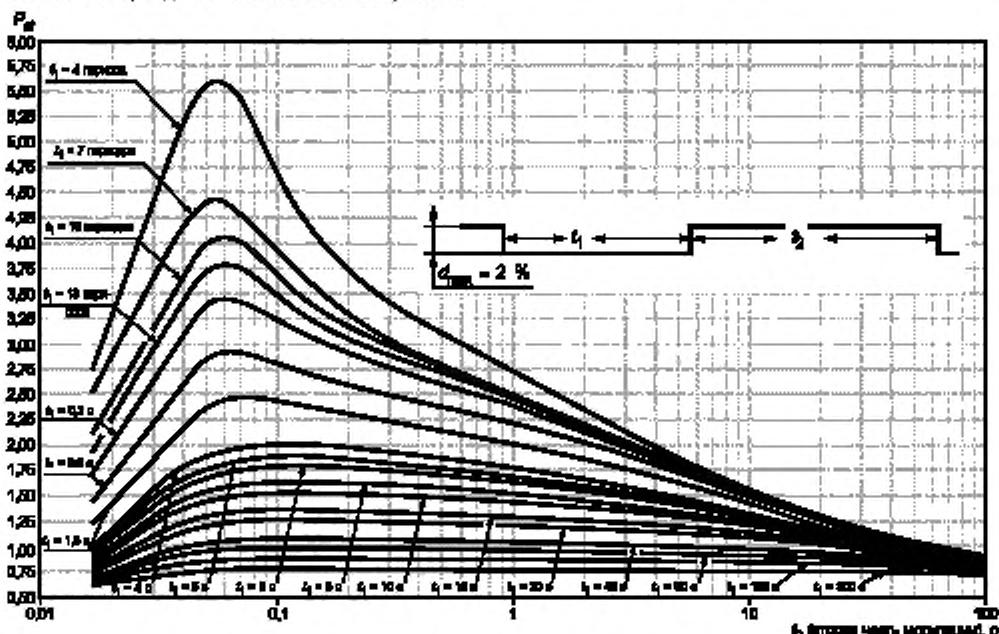
Рисунок Е.4 — Кривые коэффициента формы для апериодических изменений
