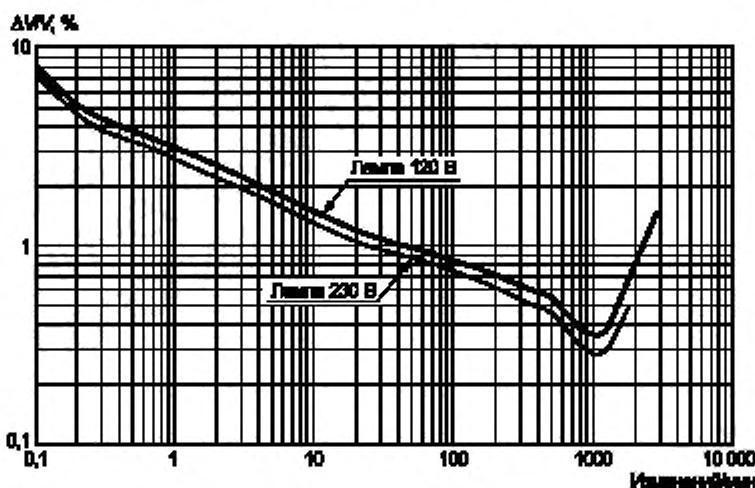
Рисунок А.1 — Кривые  $P_{st} = 1$  для регулярных прямоугольных изменений напряжения [13]Таблица А.1 — Относительные колебания входного напряжения  $\Delta V/V$  для  $P_{st} = 1,0$  на выходе [13]
