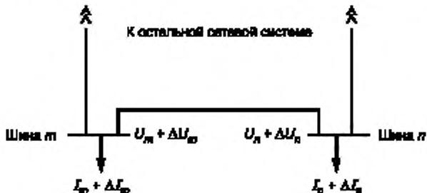
**Рисунок F.1 — Пример двух нагрузок, питаемых от разных шин**
