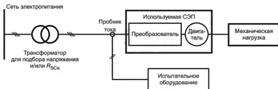
Рисунок В.6 — Испытательная установка с механической нагрузкой
