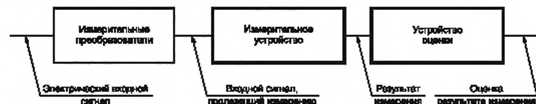
Рисунок 1 — Полная измерительная цепь
