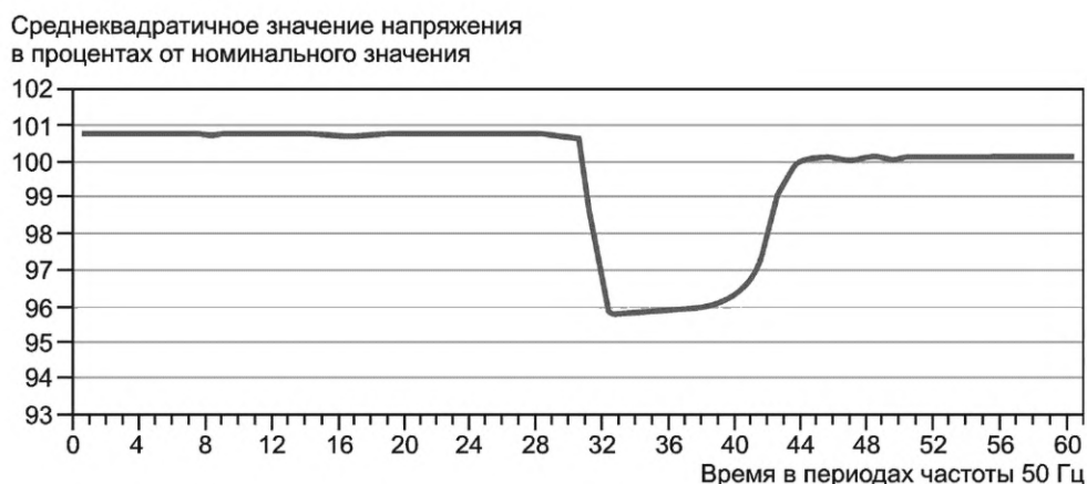
Рисунок А.1 — Типовая характеристика относительного изменения среднеквадратичного напряжения при запуске электродвигателя
