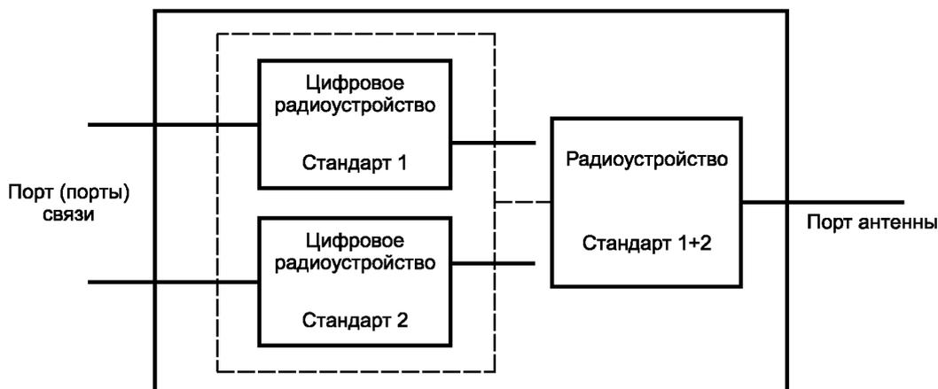
Рисунок 2 — Многокантовое радиооборудование с общим радиоинтерфейсом
