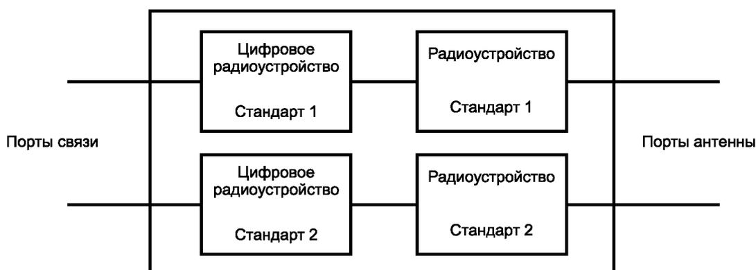
Рисунок 1 — Многокантовое радиооборудование с индивидуальными радиоинтерфейсами
