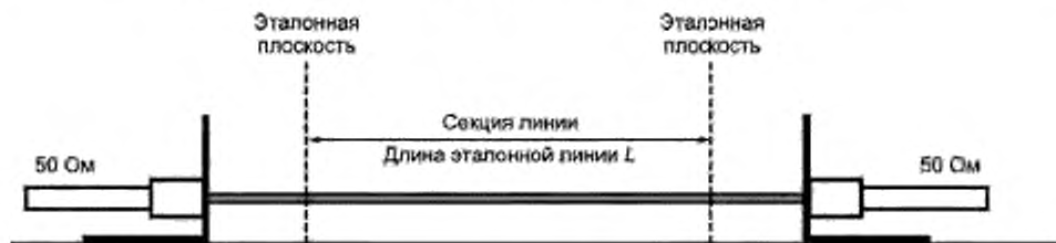
Рисунок 24d) — Конфигурация при калибровочном измерении «Линия»
