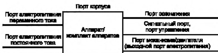
Рисунок 3 — Примеры портов аппарата/комплекта аппаратов
