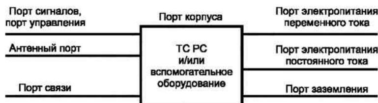
Рисунок 1 — Примеры портов оборудования
