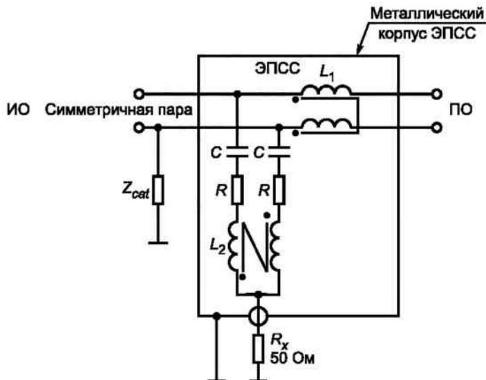
$C = 47 \text{ мкФ}$ ;  $R = 200 \text{ Ом}$ ;  $L_1 = 2 \cdot 38 \text{ мГн}$ ;  $L_2 = 2 \cdot 38 \text{ мГн}$ ;  $R_x$  — вход измерителя ИРП; ПО — подключаемое оборудование; ИО — испытуемое оборудование
