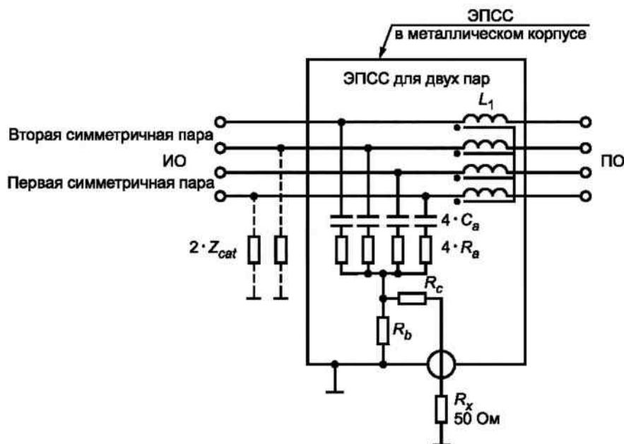
$C_a = 33 \text{ нФ}$ ;  $R_a = 576 \text{ Ом}$ ;  $R_b = 6 \text{ Ом}$ ;  $R_c = 44 \text{ Ом}$ ;  $L_1 = 4 \cdot 7 \text{ мГн}$ ;  $R_x$  — вход измерителя ИРП; ПО — подключаемое оборудование; ИО — испытуемое оборудование
