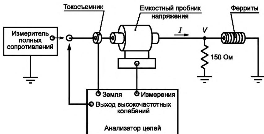
Рисунок F.4 — Установка для измерения полного сопротивления резистора 150 Ом и ферритов
