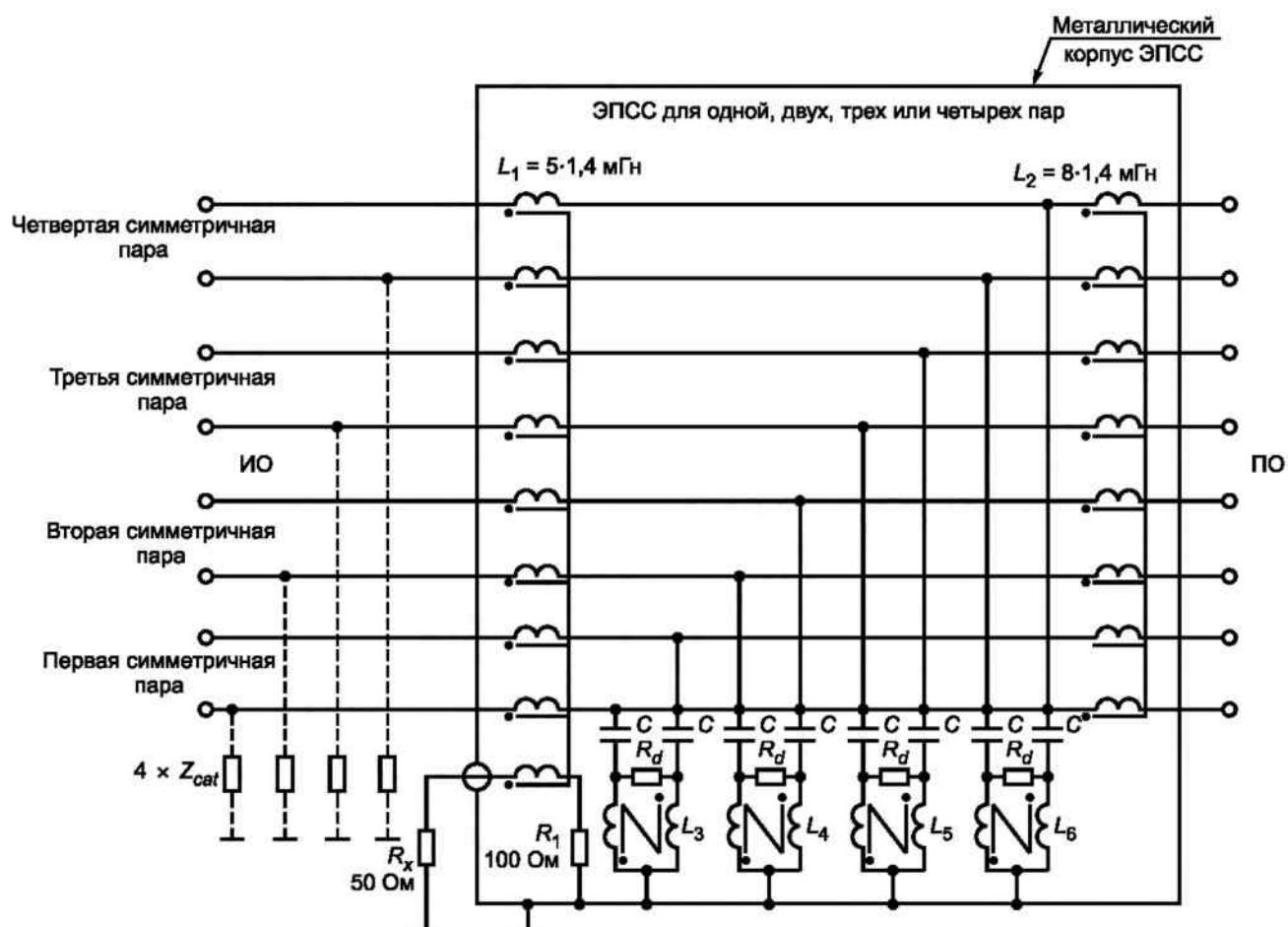
$C = 82 \text{ нФ}$ ;  $L_3, L_4, L_5, L_6 = 2 \cdot 3,1 \text{ мГн}$ ;  $R_x$  — вход измерителя ИРП;  $R_d = 390 \text{ Ом}$ ; ПО — подключаемое оборудование; ИО — испытуемое оборудование
