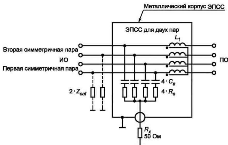
$C_a = 33 \text{ нФ}$ ;  $R_a = 400 \text{ Ом}$ ;  $L_1 = 4 \cdot 7 \text{ мГн}$ ;  $R_x$  — вход измерителя ИРП; ПО — подключаемое оборудование; ИО — испытуемое оборудование
