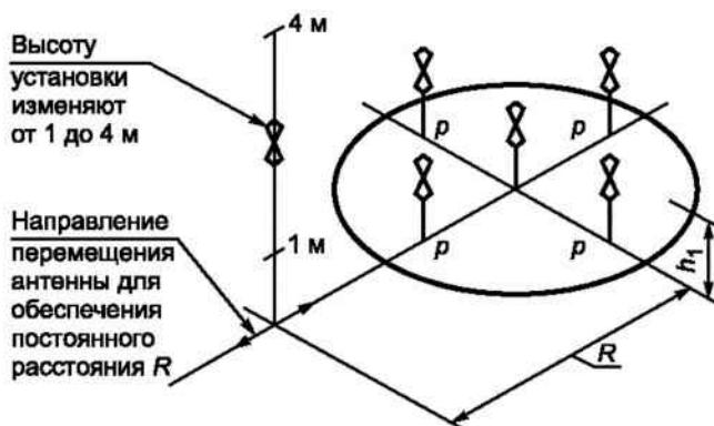
*p* — точки размещения измерительных антенн, находящихся на окружности, описываемой крайней точкой ИО при вращении на  $360^\circ$ ;  $h_1$  — высота передающей антенны ( $h_1 = 1$  и  $1,5$  м);  $R$  — расстояние между вертикальными проекциями центров передающей и приемной антенн
