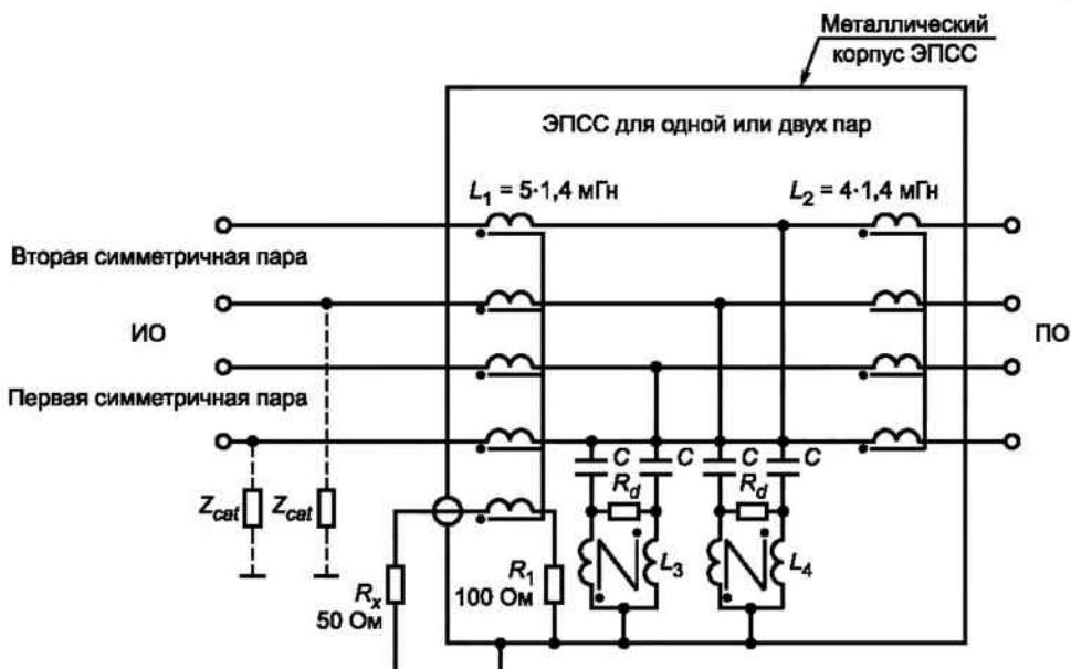
$C = 82 \text{ нФ}$ ;  $L_3 = 2 \cdot 3,1 \text{ мГн}$ ;  $L_4 = 2 \cdot 3,1 \text{ мГн}$ ;  $R_d = 390 \text{ Ом}$ ;  $R_x$  — вход измерителя ИРП; ПО — подключаемое оборудование; ИО — испытуемое оборудование;  $L_3$  и  $L_4$  обеспечивают индуктивность дифференциального режима  $4 \cdot 3,1 = 12,4 \text{ мГн}$
