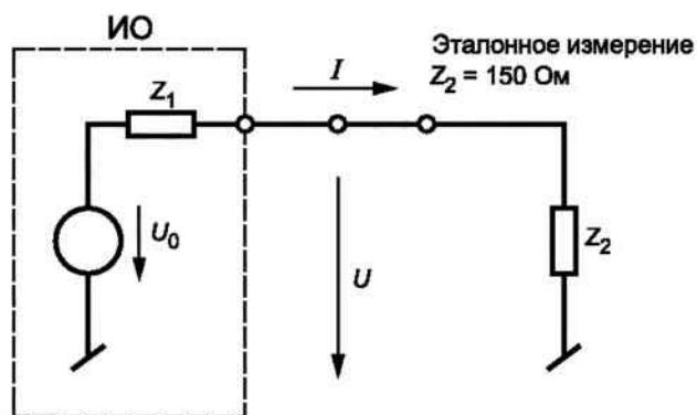
ИО — испытуемое оборудование;  $Z_1$  — общее несимметричное полное сопротивление ИО;  $U_0$  — напряжение источника ИРП;  $U$  — общее несимметричное напряжение ИРП на порте связи;  $I$  — общий несимметричный ток ИРП на порте связи;  $Z_2 = 150 \text{ Ом}$  — общее несимметричное полное сопротивление нагрузки
