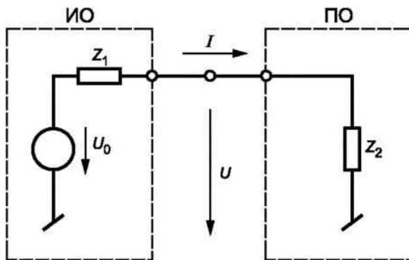
ИО — испытуемое оборудование; ПО — подключаемое оборудование;  $Z_1$  — общее несимметричное полное сопротивление ИО;  $U_0$  — напряжение источника ИРП;  $U$  — общее несимметричное напряжение ИРП на порте связи;  $I$  — общий несимметричный ток ИРП на порте связи;  $Z_2$  — общее несимметричное полное сопротивление ПО
