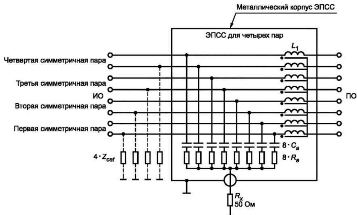
$C_a = 33 \text{ нФ}$ ;  $R_a = 800 \Omega$ ;  $L_1 = 8 \cdot 7 \text{ мГн}$ ;  $R_x$  — вход измерителя ИРП; ПО — подключаемое оборудование;
