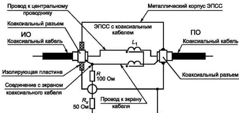
$R_x$  — вход измерителя ИРП; дроссель общего несимметричного режима  $L_1 = 2 \cdot 7 \text{ мГн}$ ; ПО — подключаемое оборудование;
