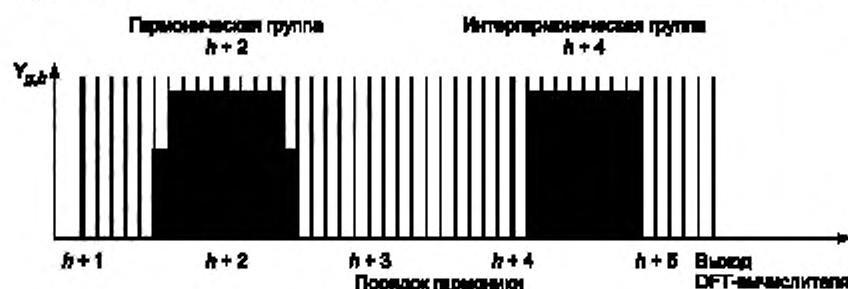
Рисунок 4 — Схема образования гармонических и интергармонических групп (для систем электроснабжения частотой 50 Гц)
