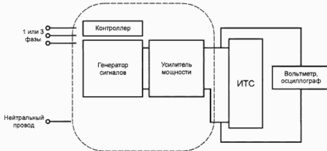
Рисунок 3 — Схема испытательного оборудования с усилителем мощности
